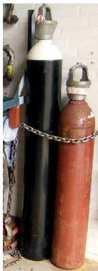
Fastgjort – og sikret mod at vælte.
