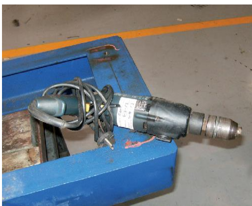
Boremaskine med inspektionsmærke. Vær opmærksom på datoen.
