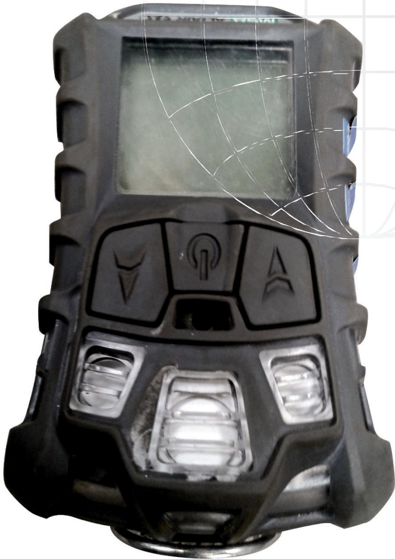
Gastester. Et instrument til måling af luftens indhold af forskellige gasser.
